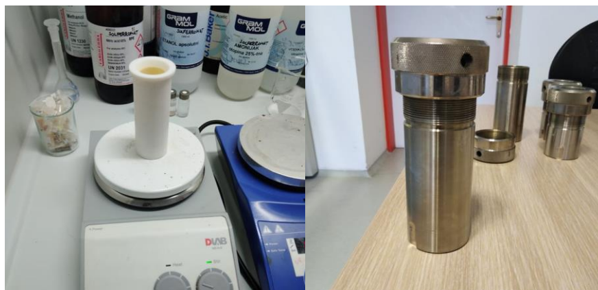
Slika 14. Prikaz autoklava i teflonskog uložka na magnetskoj miješalici.
