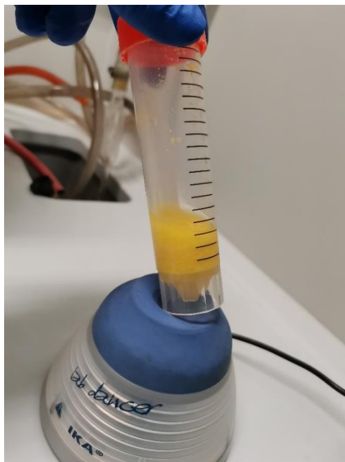
Slika 17: Miješanje sadržaja kivete laboratorijskom treskalicom.
