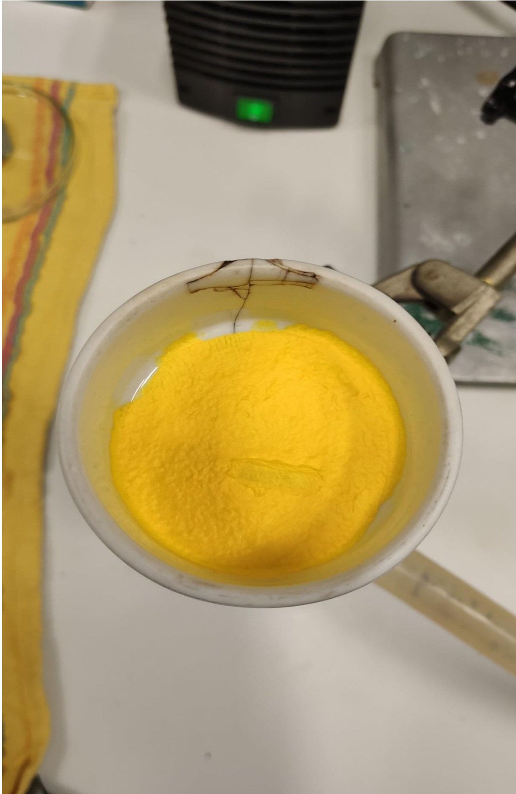
Slika 12: Talog spoja 4AA nakon vakuum filtracije
