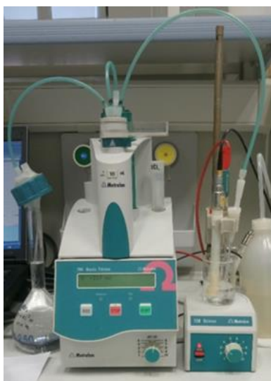
Slika 28. Automatski univerzalni titrator 794 Basic Titrino i pripadajuća jedinica za doziranje 806 Exchange Unit te magnetska mješalica 728 Stirer.
