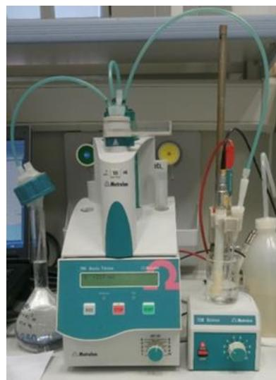
**Slika 28.** Automatski univerzalni titrator 794 Basic Titrino i pripadajuća jedinica za doziranje 806 Exchange Unit te magnetska mješalica 728 Stirer.
