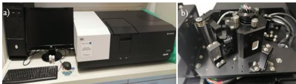
Slika 48. a) Shimadzu UV-3600 Plus UV/VIS NIR spektrofotometar; b) Integracijska sfera.
