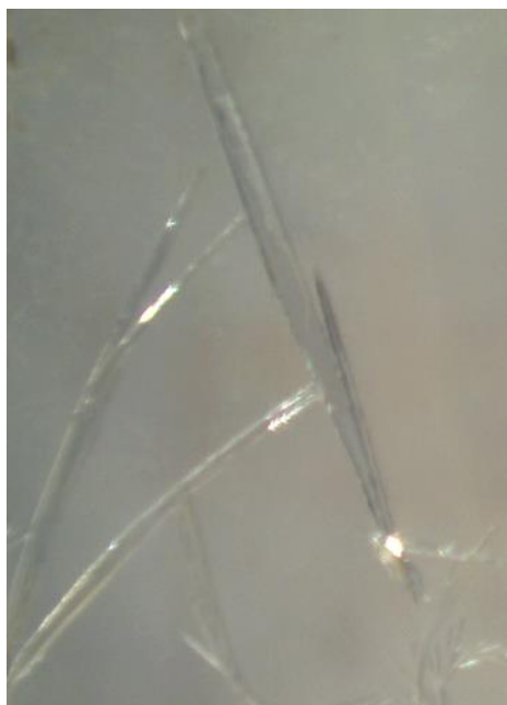
Slika 30. Igličasti kristali spoja Do3OH pripravljeni metodom evaporacije uz otapalo EMK
