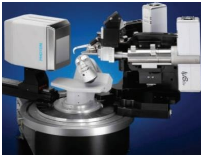
Slika 19. Rendgenski difraktometar za jedinične kristale zasnovan na CMOS-u [25]
