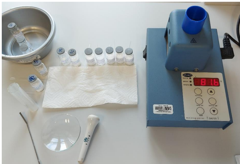
Slika 12. Pribor potreban za određivanje tališta uzorka i Stuartov digitalni uređaj
