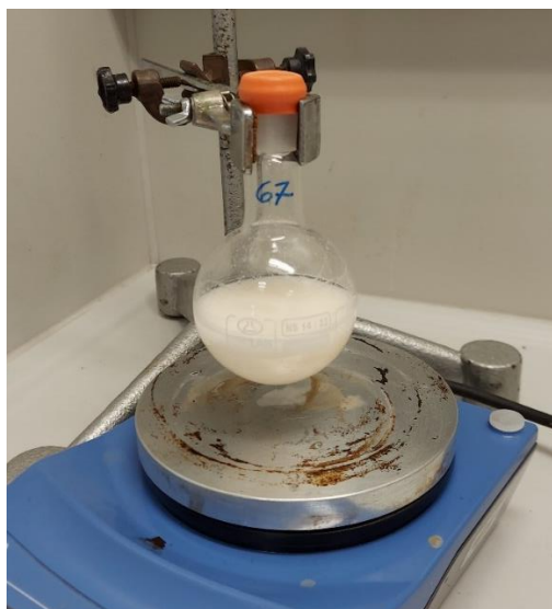
Slika 10. Aparatura za sintezu 1,3-dioktadecil-1 H -imidazol-3-ijeva tetrafenilborata ( 67 )
