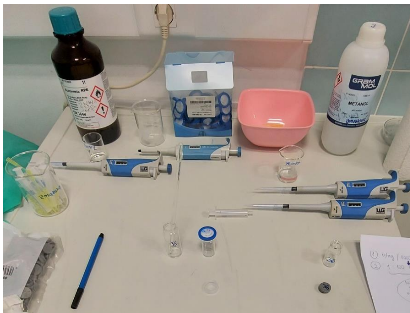
Slika 15. Pribor potreban za pripremu uzorka za MS analizu
