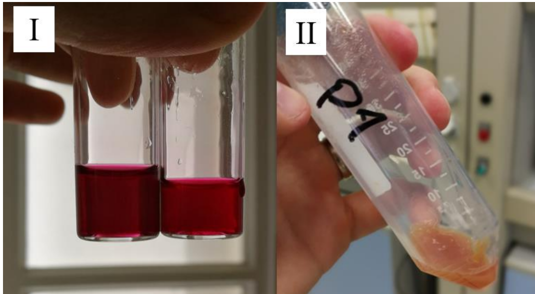
Slika 5. usporedba P1 otopine prije (I desno) i nakon dodatka askorbinske kiseline (I lijevo); gel nakon neutralizacije i ispiranja (II)
