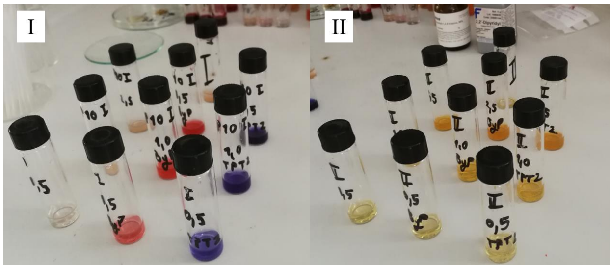
Slika 19. Priređene otopine P10-I hidrogela (lijevo), uz dodatak 2,2-bipiridina (sredina) i TPTZ (desno) pri različitim razrjeđenjima (I); Priređene otopine P10-II hidrogela (lijevo), uz dodatak 2,2-bipiridina (sredina) i TPTZ (desno) pri različitim razrjeđenjima (II)
