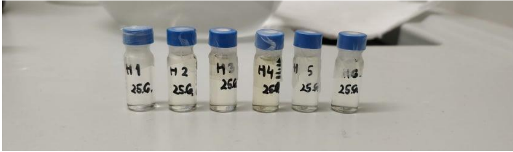
Slika 37. Uzorci pripremljeni mikrovalnom ekstrakcijom spremni za analizu plinskom kromatografijom
