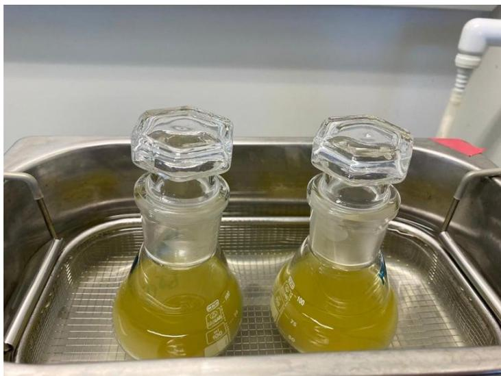
**Slika 38.** Indirektna ultrazvučna ekstrakcija uzoraka
