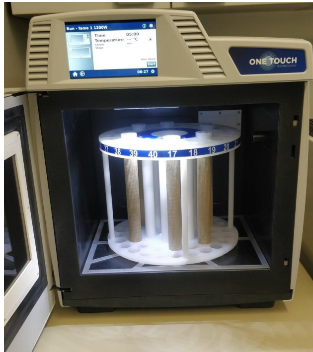
Slika 34. Pravilno poslagani uzorci za mikrovalnu ekstrakciju
