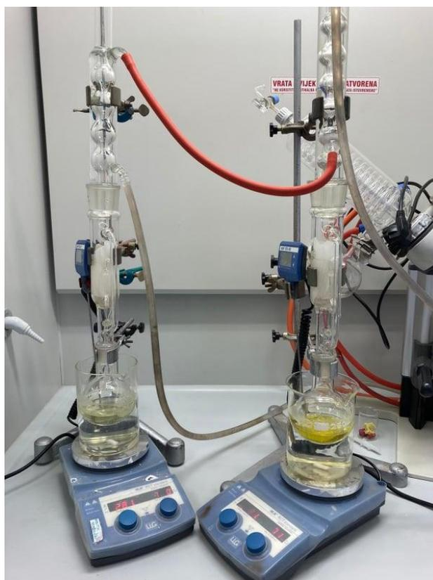
**Slika 31.** Aparatura za ekstrakciju Soxhlet metodom
