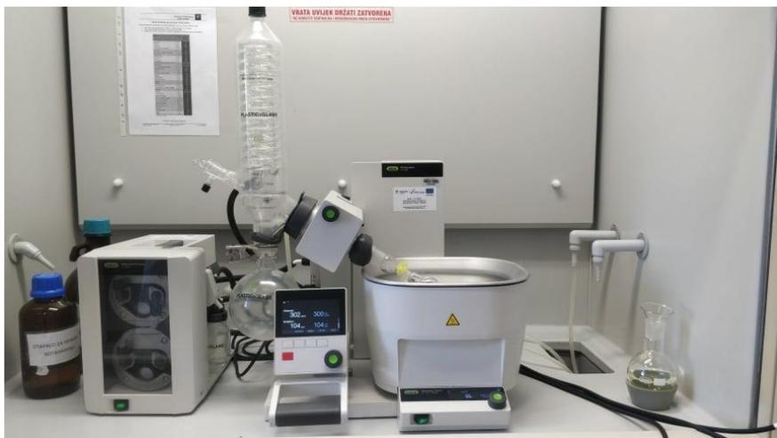
**Slika 32.** Uparavanje uzorka na rotacijskom uparivaču
