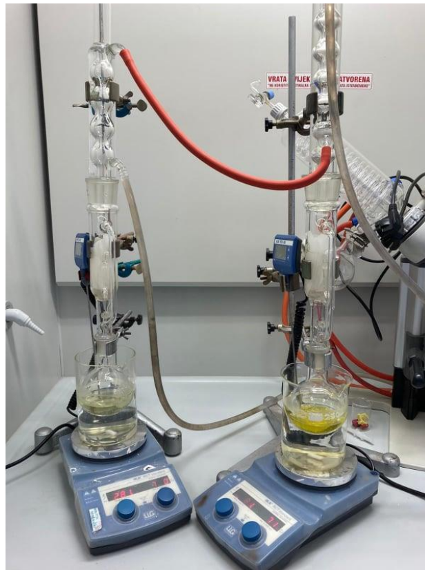
Slika 31. Aparatura za ekstrakciju Soxhlet metodom
