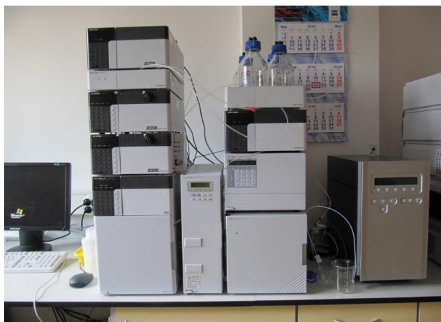
Slika 3. Uređaj za tekućinsku kromatografiju visoke djelotvornosti [26].
