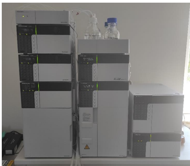
Slika 16. Tekućinski kromatograf visoke djelotvornosti.
