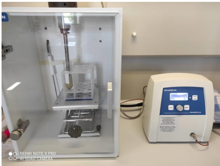
Slika 9. Sustav za ultrazvučnu homogenizaciju (Sonoplus 3100, Bandelin, Berlin, Njemačka).
