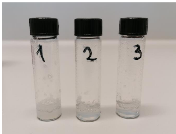
Slika 11. Kompoziti hidrogel-inzulin pripremljeni u tri različita omjera hidrogela, inzulina i vode.
