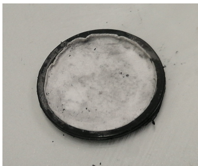
Slika 48. Gornji dio Litjevog akumulatora
