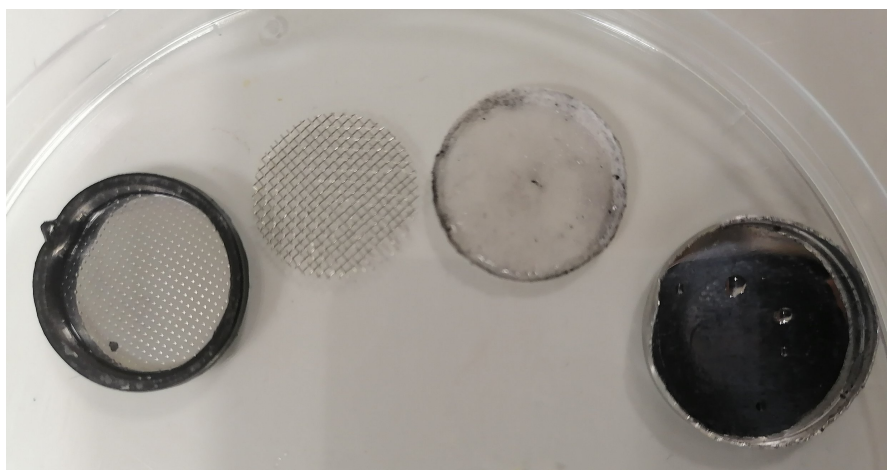
Slika 47. Očišćene konstrukcijske komponente litijeve baterije tipa CR2032
