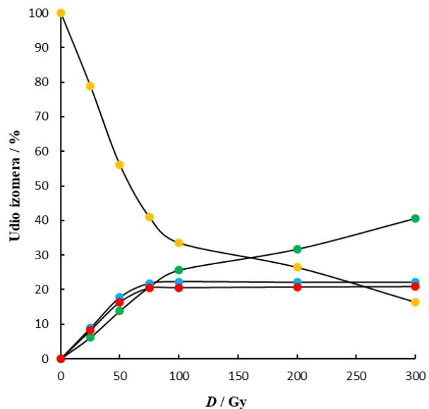
Slika 25. Raspodjela geometrijskih izomera LH u ovisnosti o brzini zračenja pri anaerobnim uvjetima,  $pH = 5$ ,  $P = 0,128 \text{ Gy/s}$ ,  $c(\text{Na}_2\text{S}) = 0,2 \text{ mmol dm}^{-3}$ , (●)  $9c,12c-18:2$  metil linoleat, (●)  $9t,12c-18:2$ , metil linoleat, (●)  $9c,12t-18:2$  metil linoleat, (●)  $9t,12t-18:2$ , metil linolelaidat
