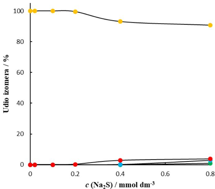
*Slika 29. Raspodjela geometrijskih izomera LH u ovisnosti o koncentraciji Na<sub>2</sub>S pri aerobnim uvjetima, D = 50 Gy, pH = 5, P = 0,5 Gy/s, (●) 9c,12c-18:2 metil linoleat, (●) 9t,12c-18:2 metil linoleat, (●) 9c,12t-18:2 metil linoleat, (●) 9t,12t-18:2 metil linolelaidat*
