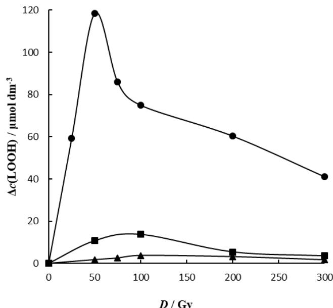
Slika 33. Promjena koncentracije LOOH nastalih promjenom pH u aerobnim uvjetima,  $P = 0,5 \text{ Gy/s}$ ,  $c(\text{Na}_2\text{S}) = 0,2 \text{ mmol dm}^{-3}$ , (●)  $\text{pH} = 5$ , (■)  $\text{pH} = 3$ , (▲)  $\text{pH} = 7$
