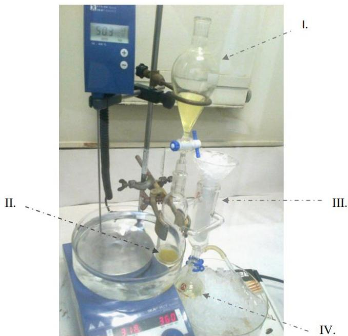
Slika 16. Aparatura za sintezu diazometana
