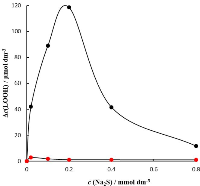
Slika 28. Utjecaj koncentracije  $\text{Na}_2\text{S}$  na nastajanje LOOH ozračivanjem dozom od 50 Gy pri  $pH = 5$ ,  $P = 0,5 \text{ Gy/s}$ , (•) aerobni uvjeti, (●) anaerobni uvjeti
