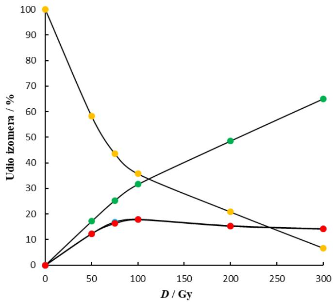
Slika 38. Raspodjela geometrijskih izomera LH pri  $pH = 7$  pri anaerobnim uvjetima,  $P = 0,5$  Gy/s,  $c(Na_2S) = 0,2 \text{ mmol dm}^{-3}$  (●) 9c,12c-18:2 metil linoleat, (●) 9t,12c-18:2, metil linoleat, (●) 9c,12t-18:2 metil linoleat, (●) 9t,12t-18:2, metil linolelaidat
