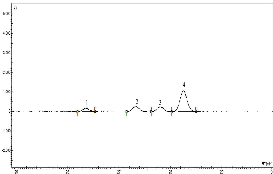
Slika 26. Kromatogram izomera LH nastalih pri dozi od 300 Gy u aerobnim uvjetima, (1) 9t,12t-18:2, metil linolelaidat; (2) 9t,12c-18:2, metil linoleat; (3) 9c,12t-18:2 metil linoleat; (4) 9c,12c-18:2 metil linoleat
