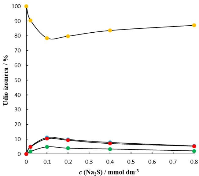
*Slika 30. Raspodjela geometrijskih izomera LH u ovisnosti o koncentraciji Na<sub>2</sub>S pri anaerobnim uvjetima, D = 50 Gy, pH = 5, P = 0,5 Gy/s, (●) 9c,12c-18:2 metil linoleat, (●) 9t,12c-18:2 metil linoleat, (●) 9c,12t-18:2 metil linoleat, (●) 9t,12t-18:2 metil linolelaidat*
