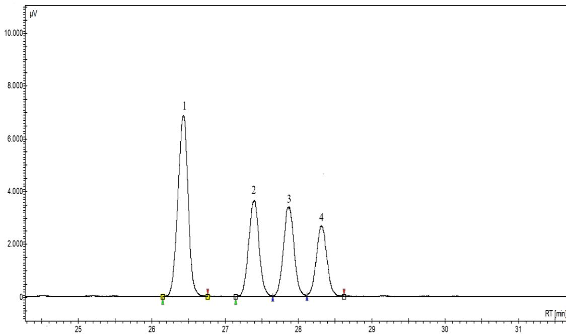
*Slika 27. Kromatogram izomera LH nastalih pri dozi od 300 Gy u anaerobnim uvjetima, (1) 9t,12t–18:2, metil linolelaidat; (2) 9t,12c–18:2, metil linoleat; (3) 9c,12t–18:2 metil linoleat; (4) 9c,12c–18:2 metil linoleat*
