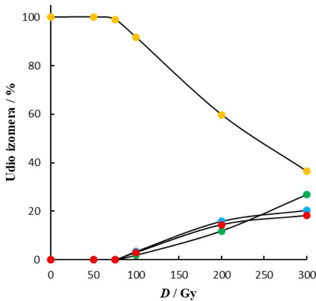
Slika 35. Raspodjela geometrijskih izomera LH pri  $\text{pH} = 3$  u aerobnim uvjetima,  $P = 0,5 \text{ Gy/s}$ ,  $c(\text{Na}_2\text{S}) = 0,2 \text{ mmol dm}^{-3}$  (●)  $9c,12c-18:2$  metil linoleat, (●)  $9t,12c-18:2$ , metil linoleat, (●)  $9c,12t-18:2$  metil linoleat, (●)  $9t,12t-18:2$ , metil linoleaidat
