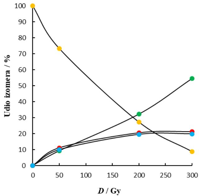
*Slika 36. Raspodjela geometrijskih izomera LH pri pH = 3 u anaerobnim uvjetima, P = 0,5 Gy/s, c (Na<sub>2</sub>S) = 0,2 mmol dm<sup>-3</sup> (●) 9c,12c-18:2 metil linoleat, (●) 9t,12c-18:2, metil linoleat, (●) 9c,12t-18:2 metil linoleat, (●) 9t,12t-18:2, metil linolelaidat*
