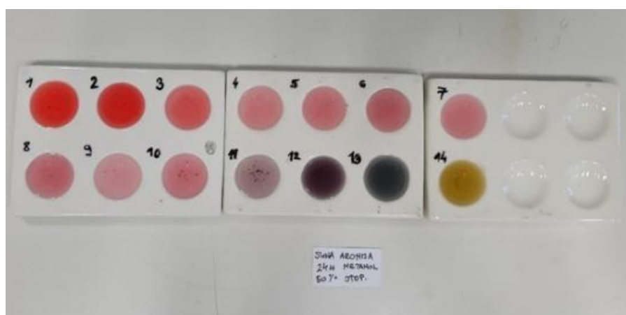
Slika 18. Alternativni kiselo-bazni indikator priređen od suhe aronije i metanola u omjerima a) 25 %, b) 50 % i c) 75 % nakon 24 sata.
