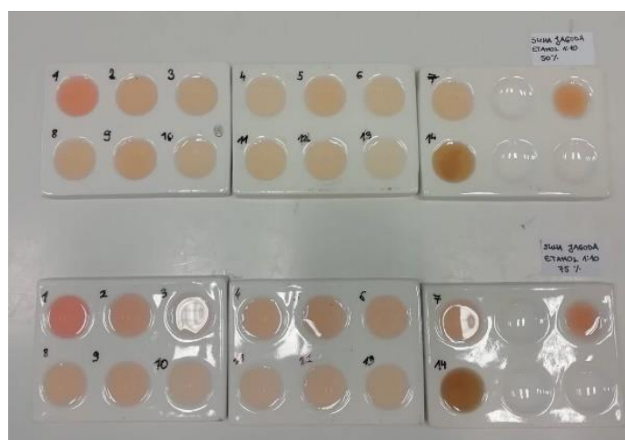
Slika 20. Rezultati primjene indikatora od suhe jagode i 50 % etanola (gore) i 75 % etanola (dolje).
