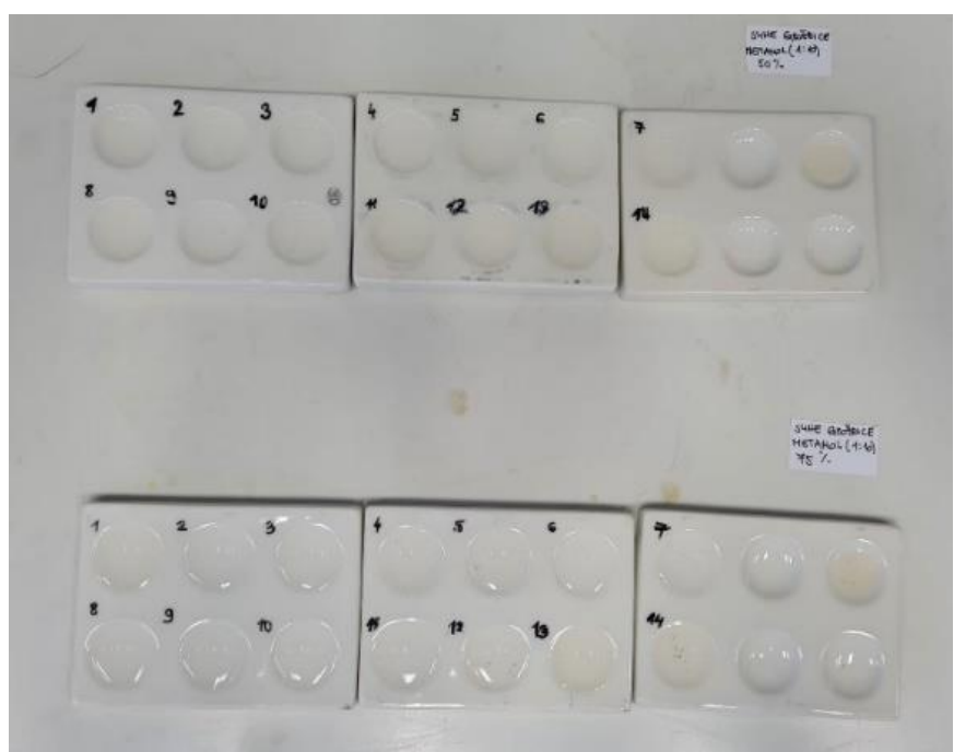
Slika 70. Rezultati primjene indikatora od grožđica i 50 % metanola (gore) i 75 % metanola (dolje).
