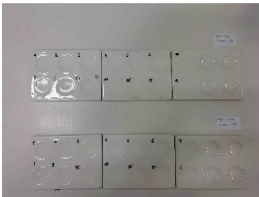
Slika 35. Rezultati primjene indikatora od svježeg bijelog duda i 50 % etanola (gore) i 75 % etanola (dolje).
