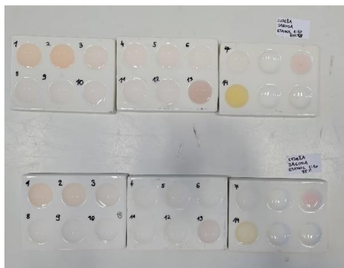
Slika 19. Rezultati primjene indikatora od svježeg jagode i 50 % etanola (gore) i 75 % etanola (dolje).
