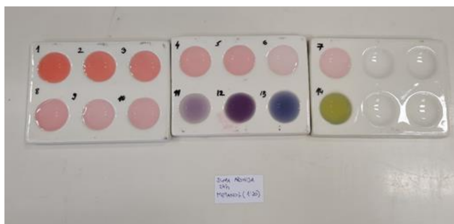
Slika 14. Alternativni kiselo-bazni indikator priređen od suhe aronije i metanola u omjerima a) 1 : 10, b) 1 : 15 i c) 1 : 20 nakon 24 sata.
