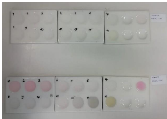
Slika 47. Rezultati primjene indikatora od svježe brusnice i 50 % etanola (gore) i 75 % etanola (dolje).
