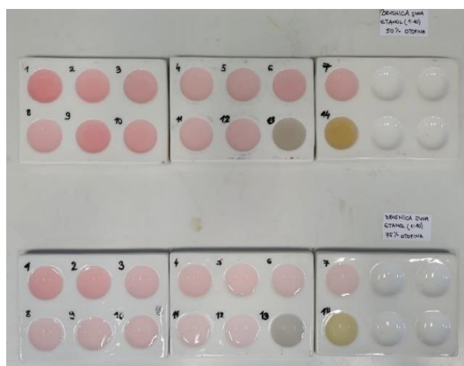
Slika 48. Rezultati primjene indikatora od suhe brusnice i 50 % etanola (gore) i 75 % etanola (dolje).
