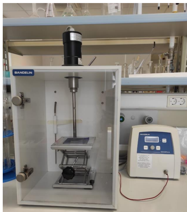
Slika 12. Sustav za ultrazvučnu homogenizaciju (Sonoplus 3100, Bandelin, Berlin, Njemačka).
