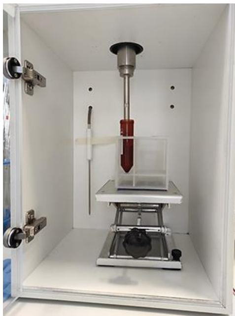
Slika 16. Direktna ekstrakcija potpomognuta ultrazvukom (UZVS).
