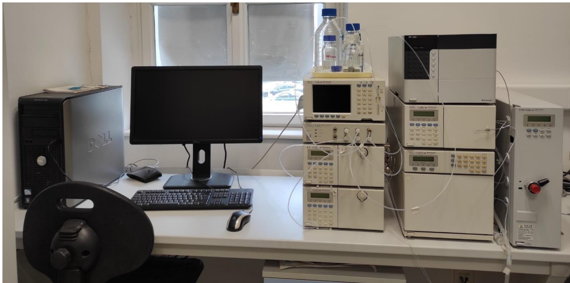
Slika 13. Uređaj za kromatografiju visoke djelotvornosti (Shimadzu).
