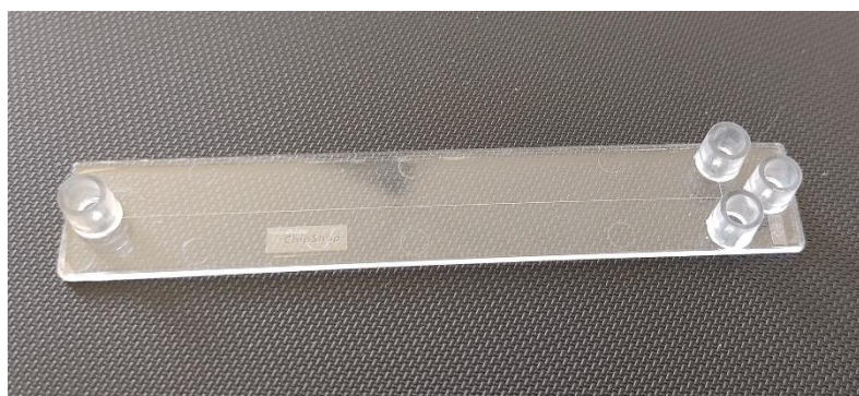
Slika 12. Mikročip korišten u elektroforetskim mjerenjima.
