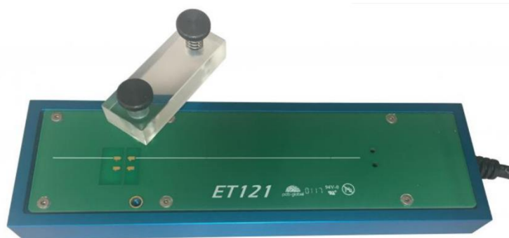
Slika 10. ET121 mikročip platforma za C 4 D detektor [46].
