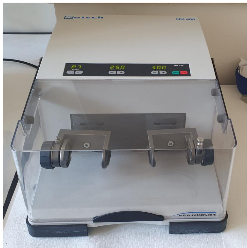
Slika 3.1: Vibracijski mlin korišten za provođenje sinteze niklovih cijanida u zeolitu Y.
