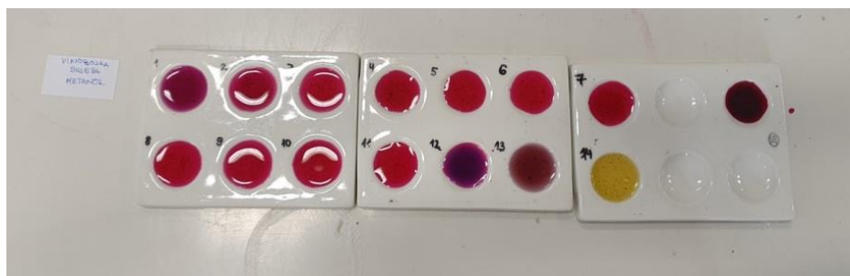
Slika 32. Indikator od svježih bobica vinobojke i metanola.
