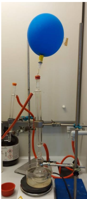
Slika 13. Aparatura za dobivanje 3,3'-(butan-1,4-diil)bis(1 H -benz[ d ]imidazol-3-ijeva) bromida (12).
