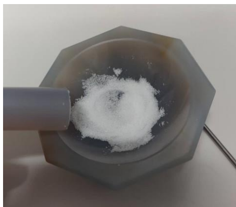
Slika 17. Homogenizacija uzorka s kalijevim bromidom za snimanje IR spektra.
