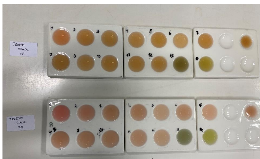
Slika 20. Indikator pripremljen od suhe trešnje i etanola.
