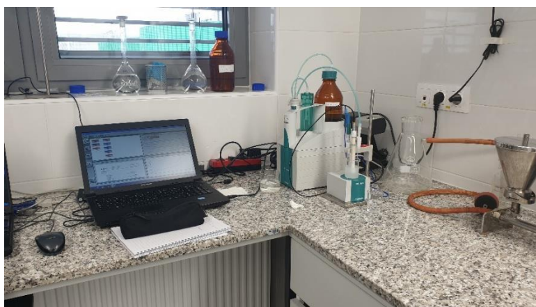
Slika 20. Sustav za potenciometrijske titracije (Titrator 808 Titrand).
