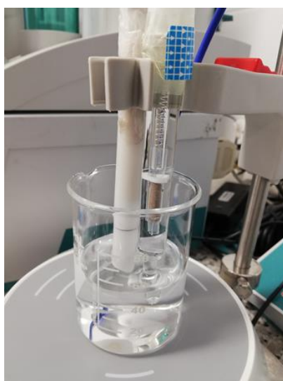
Slika 18. Mjerni sustav: Senzor za tenzide (lijevo) i referentna elektroda (desno) uronjeni u vodenu otopinu analita.
