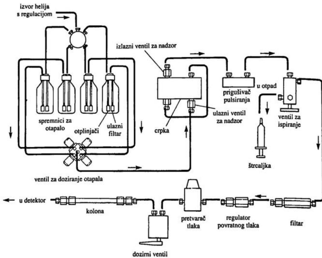
Slika 4. Shematski prikaz instrumentacije za HPLC [17].
