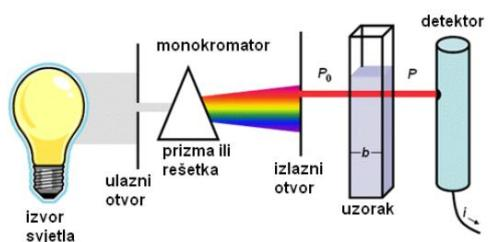
Slika 5. Shematski prikaz UV/VIS spektrofotometra [18].
