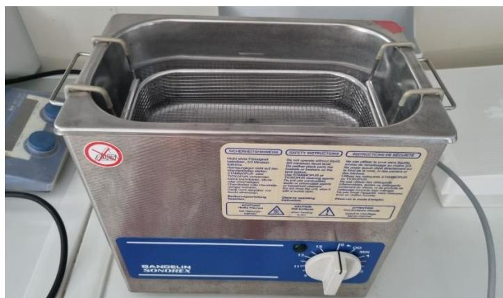
**Slika 6.** Ultrazvučna kupelj.
