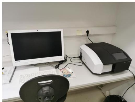
**Slika 10.** UV/VIS spektrofotometar.
