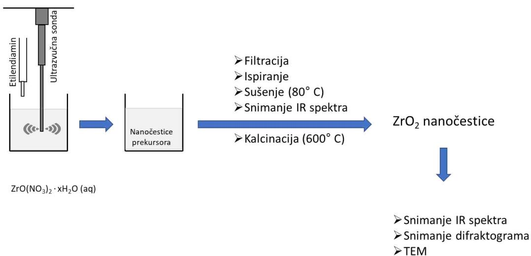
**Slika 13.** Shematski prikaz postupka sinteze nanočestica  $\text{ZrO}_2$ .
