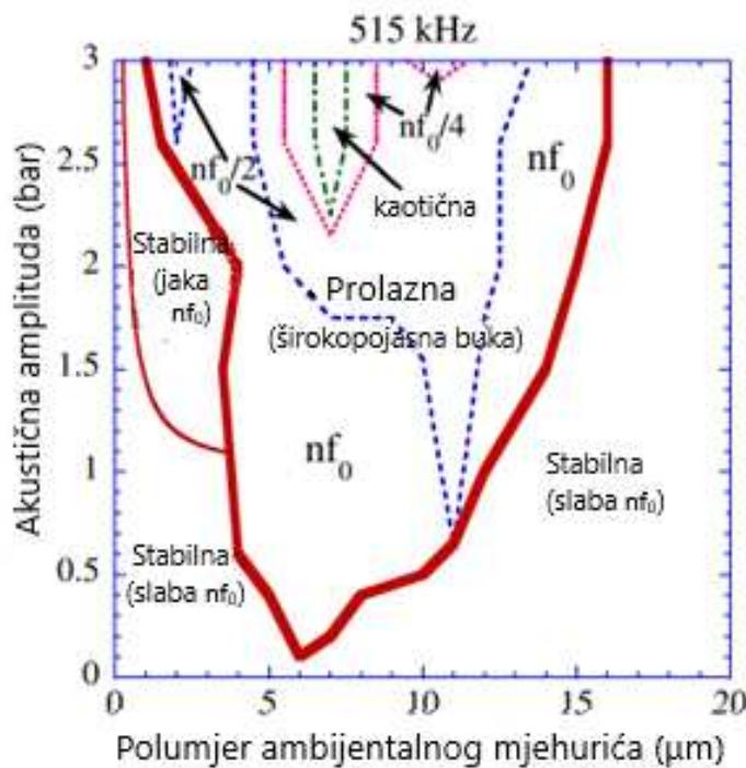
**Slika 7.** Područja prolazne i stabilne kavitacije u parametrima akustične amplitude i ambijentalnog polumjera mjeđurića pri frekvenciji ultrazvuka od 515 kHz [12].
