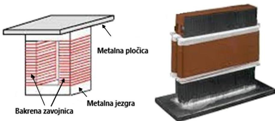
Slika 3. Shematski prikaz magnetostriktivnog transduktora [4].
