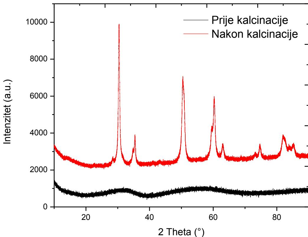
**Slika 27.** Difraktogrami uzorka sintetiziranog u ultrazvučnoj kupelji snimljeni prije i nakon kalcinacije.
