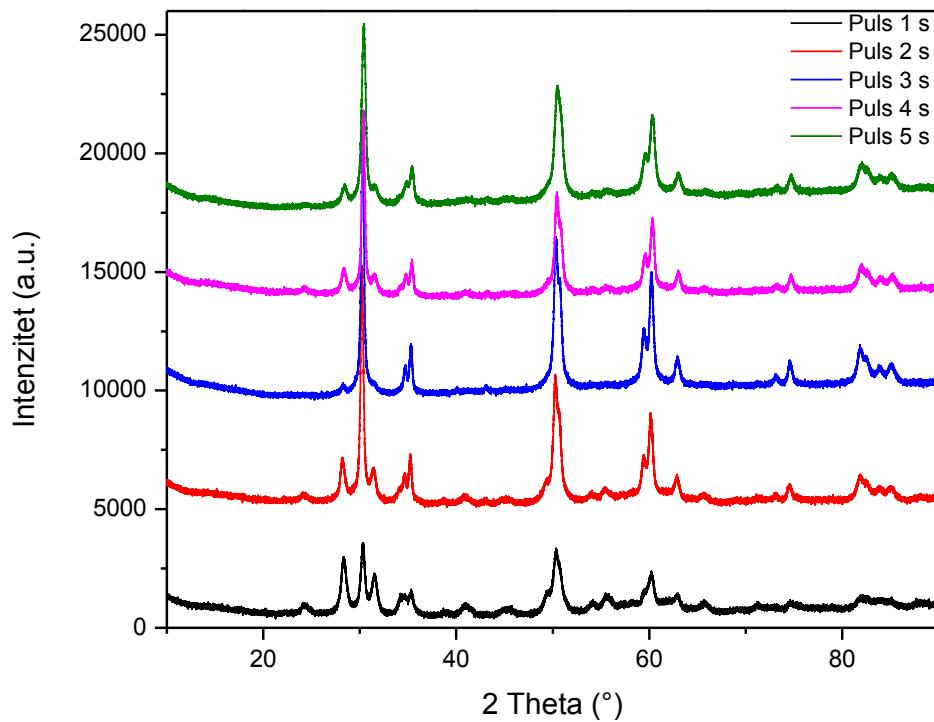
**Slika 26.** Diffraktogrami uzoraka sintetiziranih uz različita trajanja ultrazvučnog pulsa.
