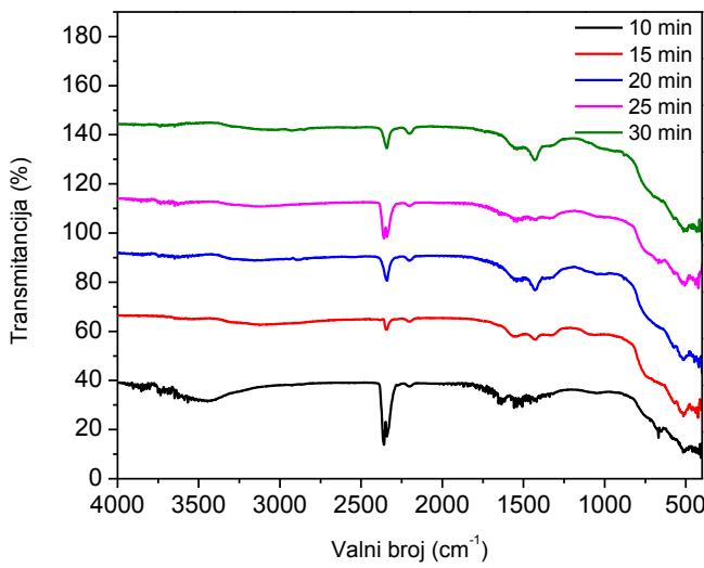
**Slika 18.** IR spektri nakon kalcinacije uzoraka sintetiziranih uz različita trajanja sinteza.
