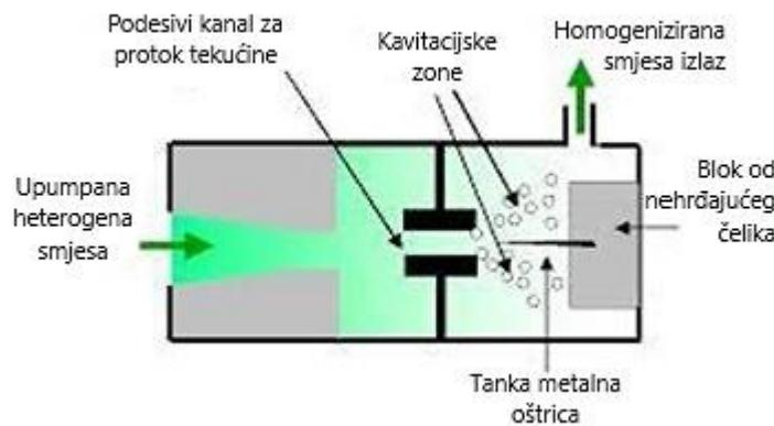
**Slika 2.** Shematski prikaz transduktora koji radi usmjeravanjem tekućine [4].
