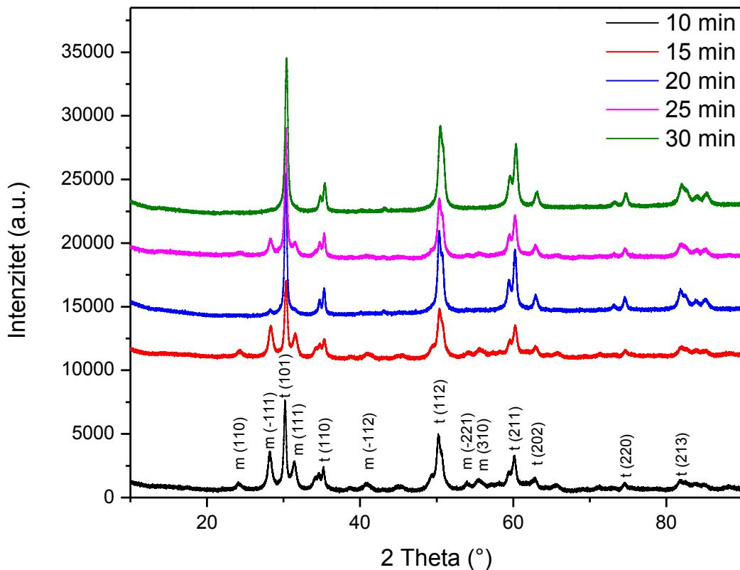
Slika 24. Difraktogrami uzoraka sintetiziranih uz različito vrijeme sinteze.
