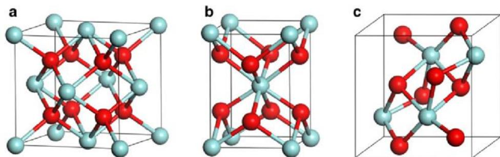
**Slika 11.** Kristalni sustavi ZrO<sub>2</sub>: a – kubični, b – tetragonski, c – monoklinski [21].
