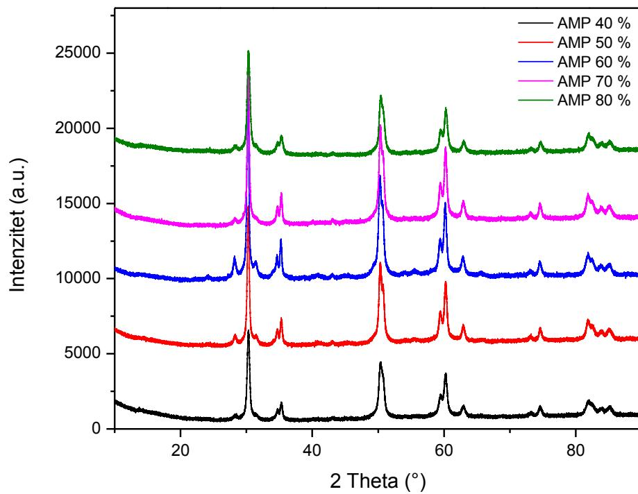
**Slika 25.** Diffraktogrami uzoraka sintetiziranih uz različite amplitudne.
