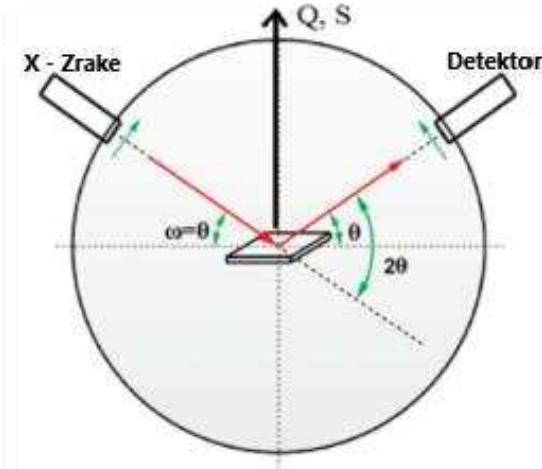
**Slika 16.** Shematski prikaz uređaja za PXRD [26].
