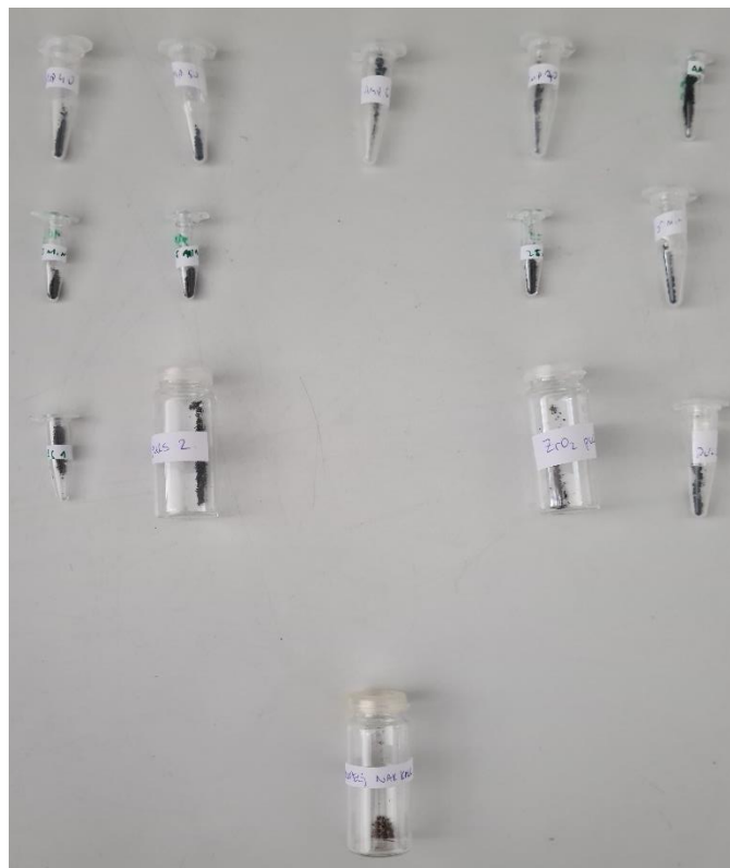
Slika 30. Uzorci s promjenom amplitude (prvi red), vremena (drugi red) i pulsa (treći red) te uzorak iz ultrazvučne kupelji (četvrti red).
