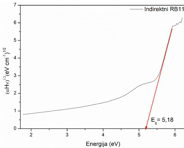
**Slika 31.** Taucov graf za izračun vrijednosti indirektnog energijskog procijepa za RB11.
