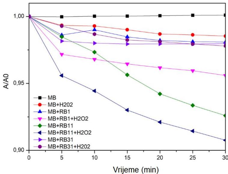
**Slika 37.** Spektar ovisnosti apsorbancije o vremenu metilen plavo (MB) uz ili bez dodatka RB1, RB11, RB31 i H<sub>2</sub>O<sub>2</sub> u vremenu od 30 min.
