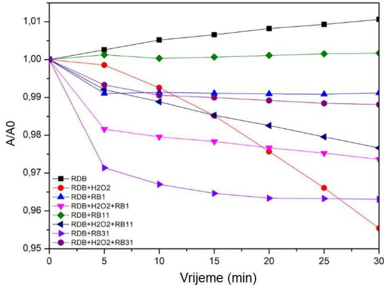
**Slika 39.** Spektar ovisnosti apsorbancije o vremenu rodamin B (RDB) uz ili bez dodatka RB1, RB11, RB31 i H<sub>2</sub>O<sub>2</sub> u vremenu od 30 min.
