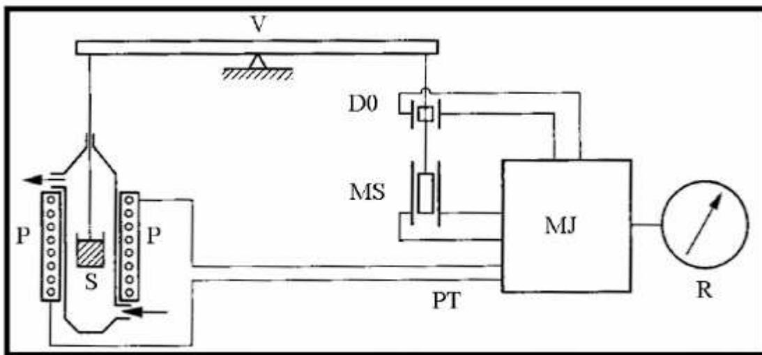
**Slika 11.** Shematski prikaz komponenti TGA uređaja [29].
