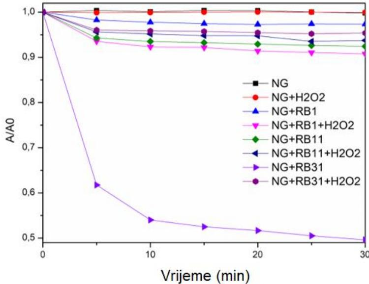
**Slika 38.** Spektar ovisnosti apsorbancije o vremenu naftol zeleno B uz ili bez dodatka RB1, RB11, RB31 i H<sub>2</sub>O<sub>2</sub> u vremenu od 30 min.
