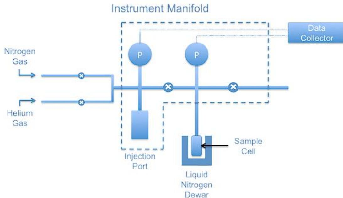
**Slika 14.** Shematski prikaz BET uređaja bez otplinjača [31].
