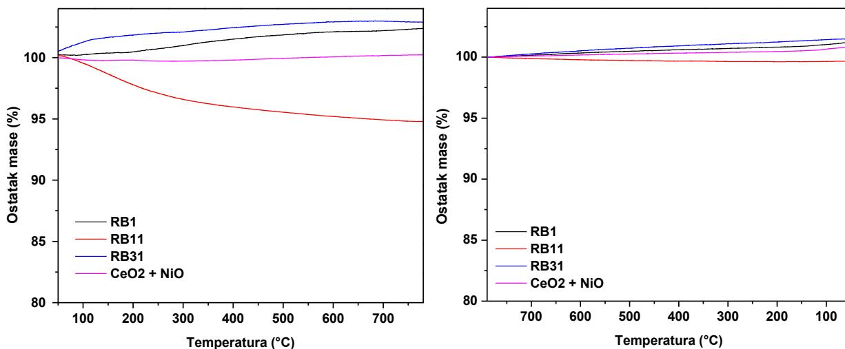
**Slika 22.** Termogrami sintetiziranih spojeva RB1, RB11 i RB31 te fizičke smjese CeO<sub>2</sub> + NiO tijekom grijanja (lijevo) i hlađenja (desno).
