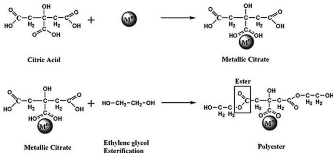
**Slika 5.** Shematski prikaz reakcija Pechinijeve metode [16].
