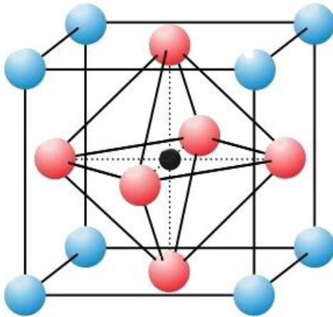
**Slika 1.** Shematski prikaz strukture kubičnog perovskita [5].
