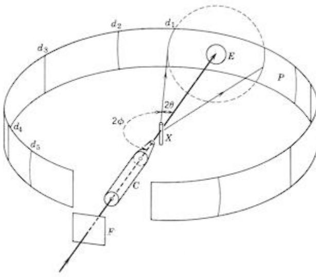
**Slika 9.** Shematski prikaz Debye–Scherer metode kamere [24].
