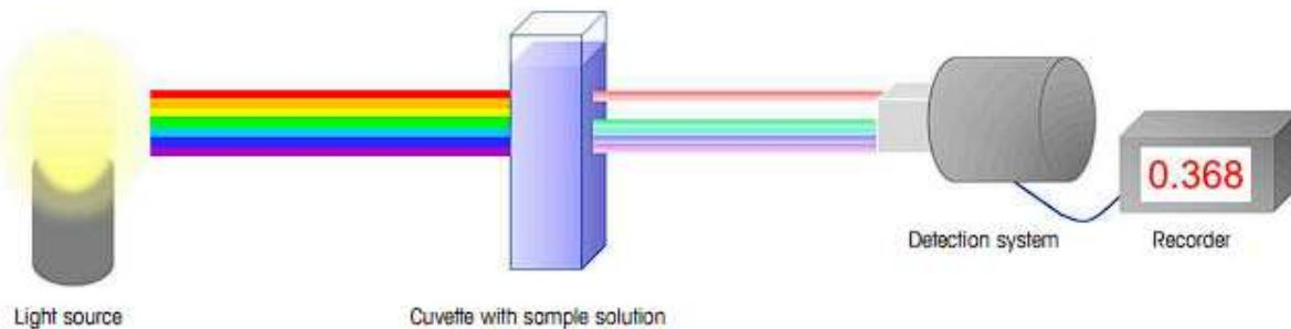
**Slika 13.** Shematski prikaz principa rada i glavnih komponenti UV/VIS uređaja [30].
