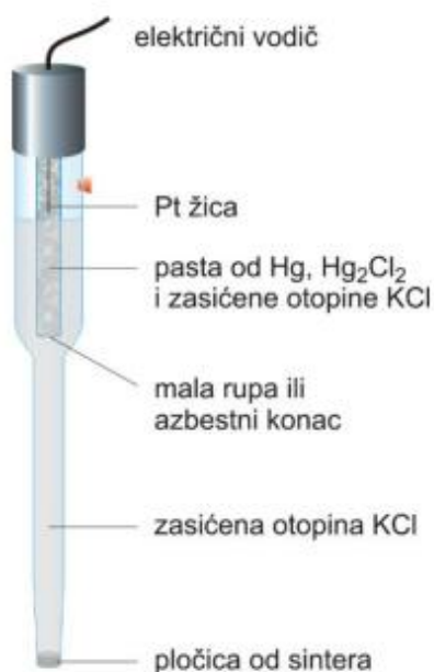
SLIKA 6. Zasićena kalomelova elektroda [12].
