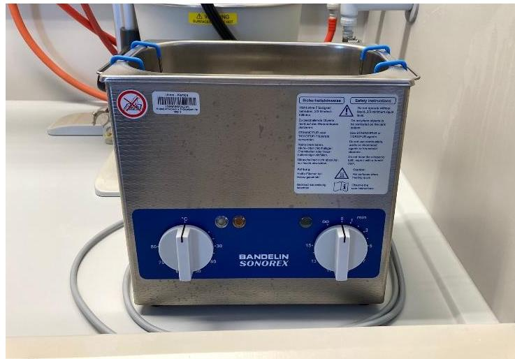
**Slika 12.** Ultrazvučna kupelj s regulatorom temperature.
