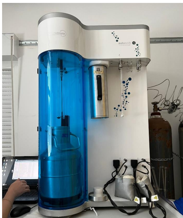
Slika 19. Autosorb iQ–MP Quantachrome uređaj za analizu specifične površine i veličine pora.
