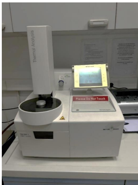
Slika 17. Mettler Toledo TGA/DSC System termogravimetrijski uređaj.
