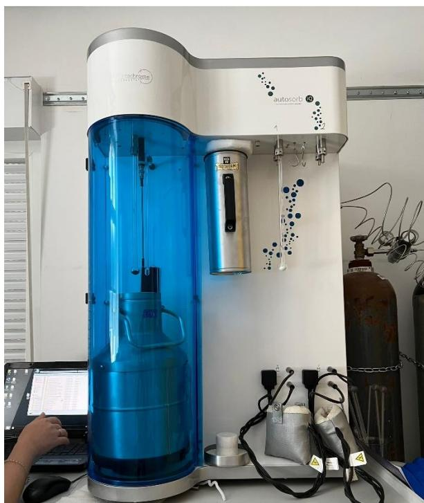
**Slika 19.** Autosorb iQ–MP Quantachrome uređaj za analizu specifične površine i veličine pora.
