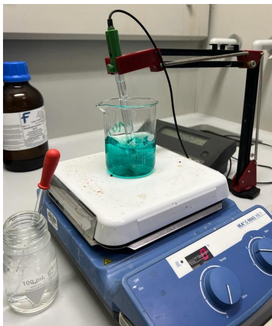
Slika 13. Podešavanje pH reakcijske smjese koristeći HANNA pH metar 221.
