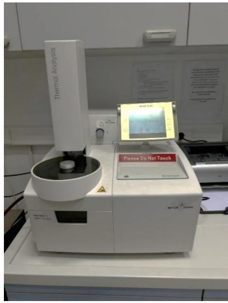
Slika 17. Mettler Toledo TGA/DSC System termogravimetrijski uređaj.
