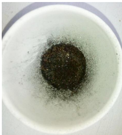
Slika 15. Uzorak sintetiziranih nanočestica srebra.
