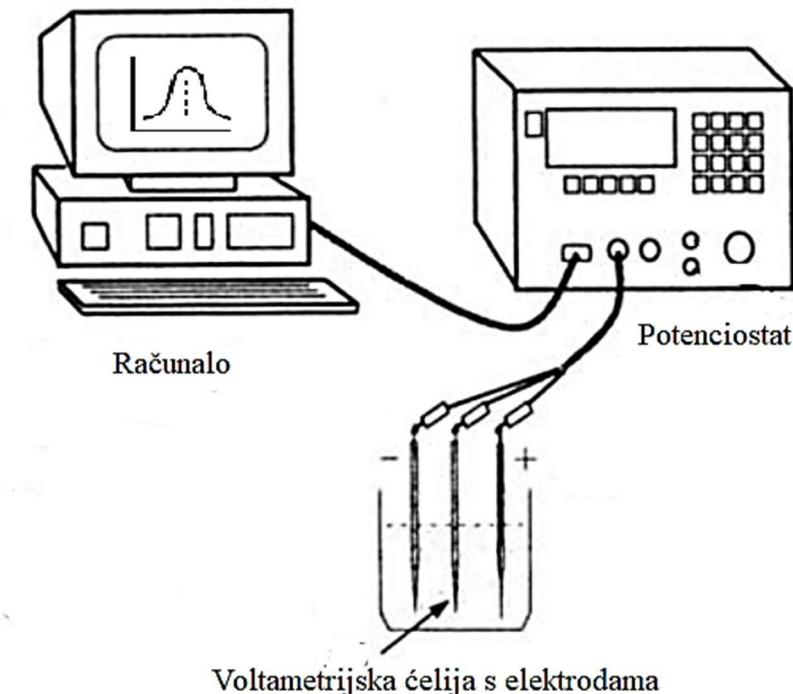
**Slika 5.** Sustav za voltametrijska mjerena sastoji se od voltametrijske ćelije, potencijostata i računala [29].
