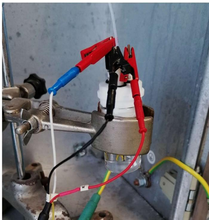
**Slika 10.** Troelektrodna voltametrijska čelija.
