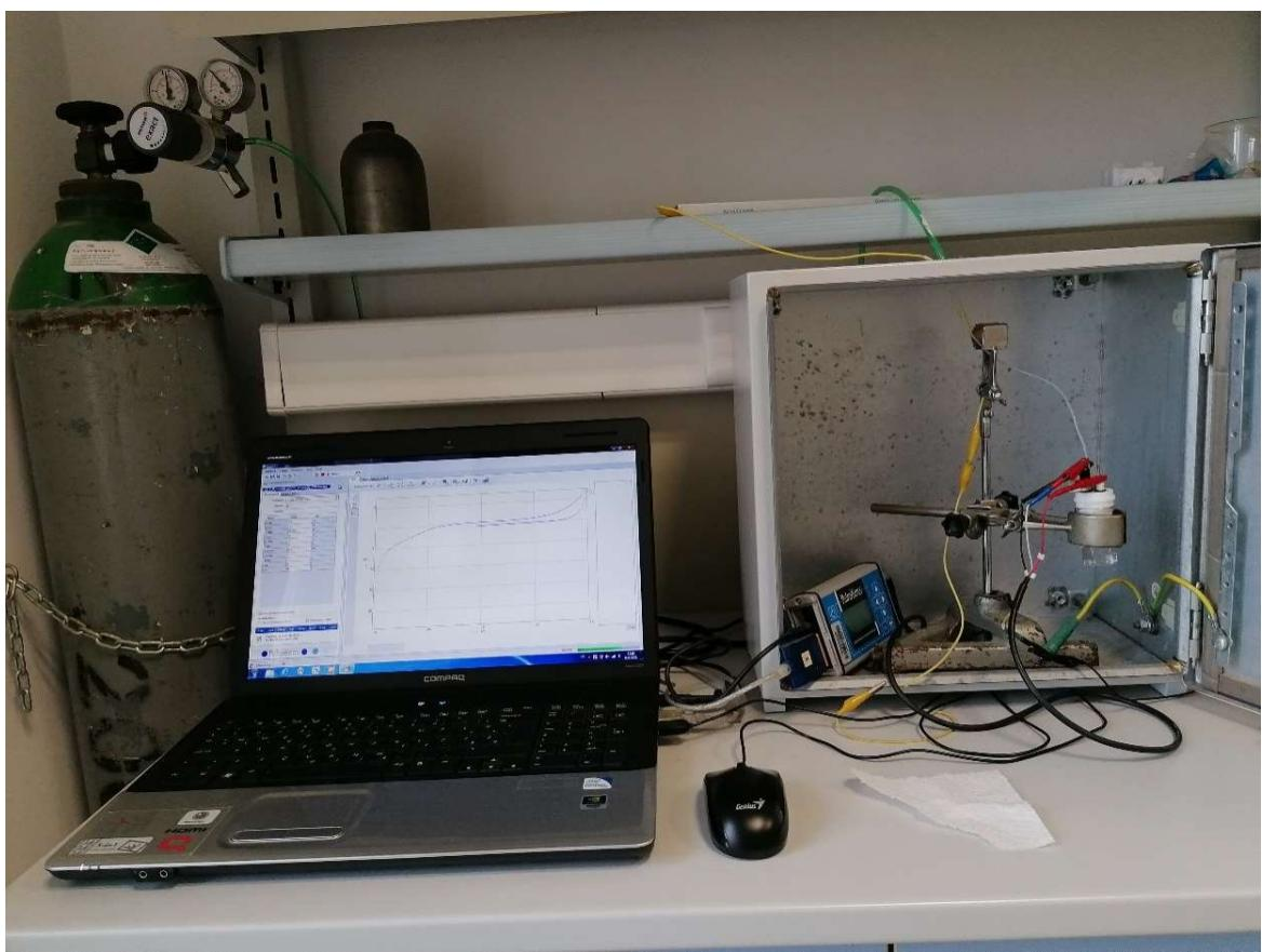
Slika 11. Aparatura za izvođenje elektrokemijskih mjerena.
