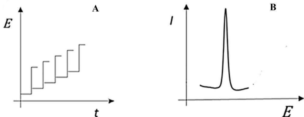
Slika 7. A) Prikaz signala pobude i B) signala odziva kod diferencijalne pulsne voltametrije.
