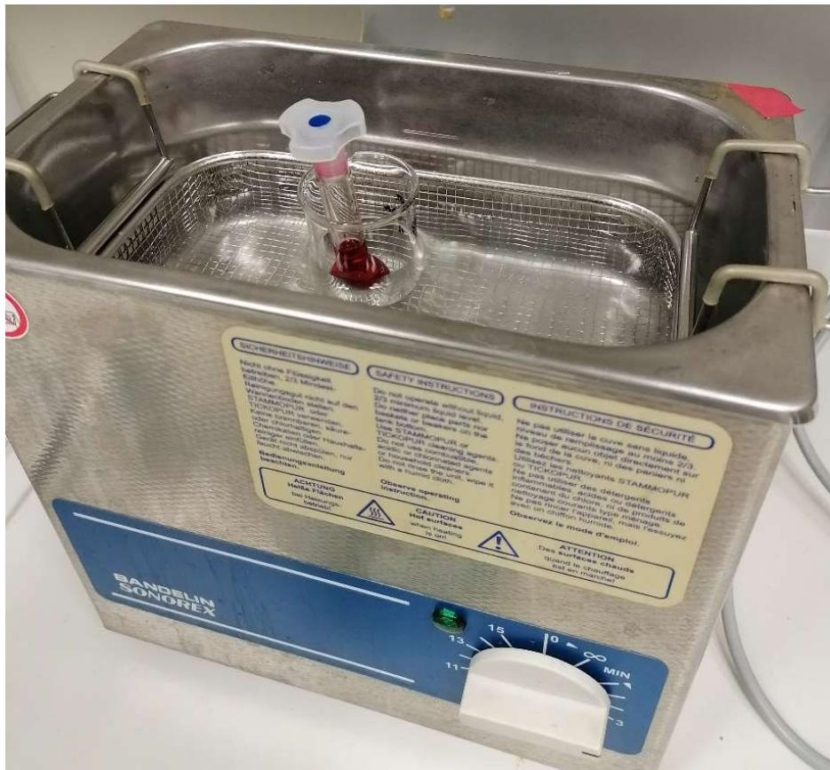
**Slika 9.** Standardna (stock) otopina vitamina B12 ( $c = 1 \cdot 10^{-3}$  mol dm $^{-3}$ ) u ultrazvučnoj kupelji.
