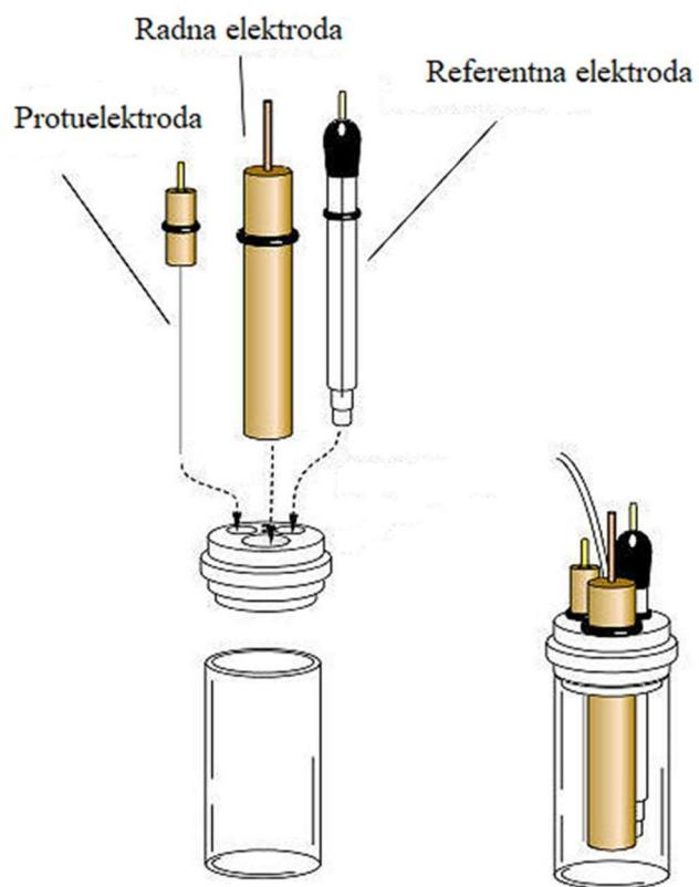
**Slika 6.** Troelektrodna voltametrijska čelija: protuelektroda, radna i referentna elektroda [31].
