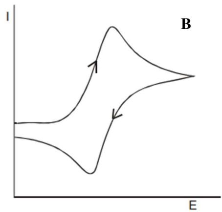
Slika 8. A) Prikaz signal pobude i B) signal odziva u cikličkoj voltametriji [33].
