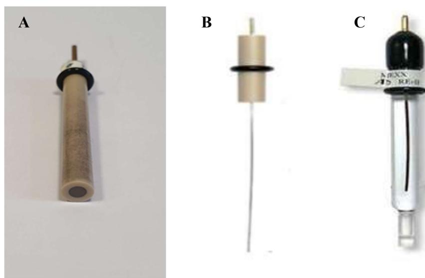
Slika 12. A) Elektroda od staklastog ugljika, B) Platinska žica, C) Ag/AgCl elektroda.
