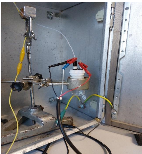
Slika 9. Prikaz troelektrodnog sustava u elektrokemijskoj ćeliji.
