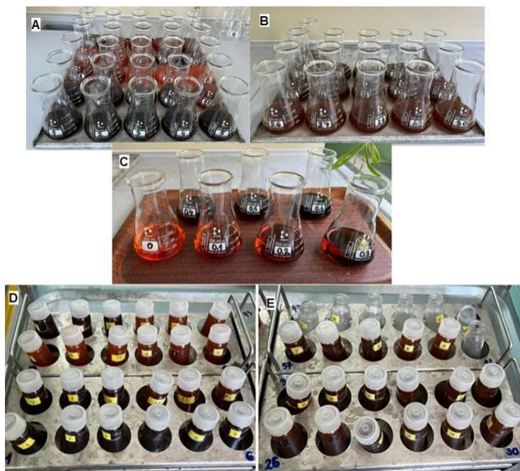
Slika 11. A) i B) Erlenmeyerove tikvice s uzorcima nakon dodatka vode, C) Erlenmeyerove tikvice sa standardima nakon dodatka vode, D) i E) kivete s uzorcima za centrifugiranje.
