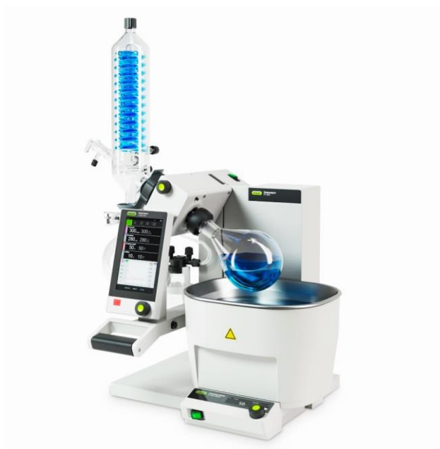
Slika 15. Rotacijski uparivač (Buchi R-300, Švicarska) (izvor: https://www.buchi.com/en/products/instruments/rotavapor-r-300 ) (Pristupljeno:18.05.2023.)
