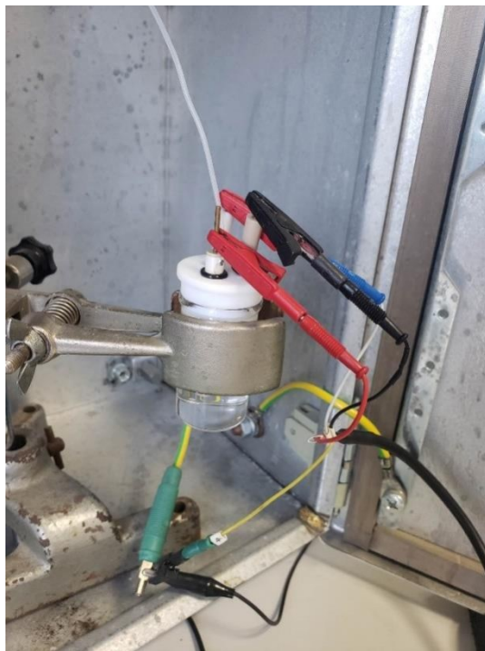
Slika 10. Troelektrodni sustav za voltametrijska mjerenja.
