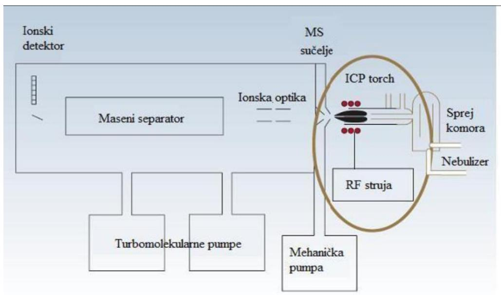
Slika 6: Shematski prikaz ICP – MS-a
