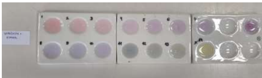
Slika 42. Indikator od latica ljubičaste orhideje i etanola.
