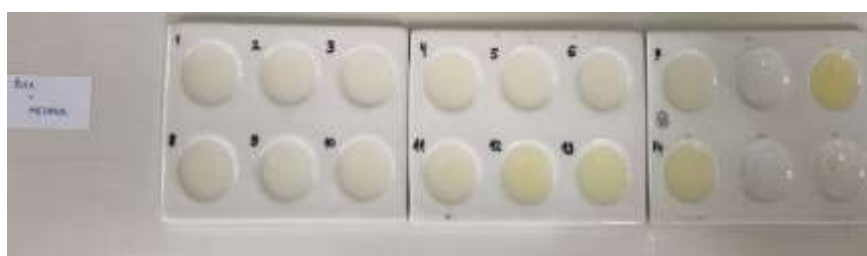
Slika 47. Indikator od latica žute orhideje i metanola.
