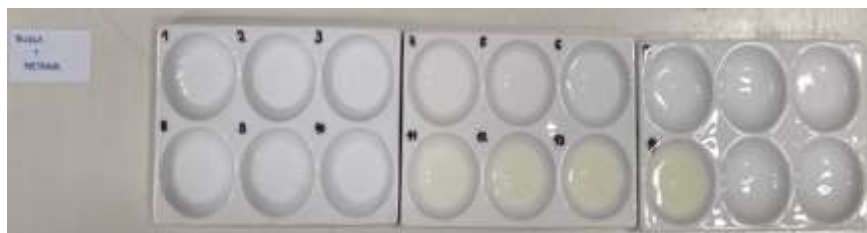
Slika 46. Indikator od latica bijele orhideje i metanola.
