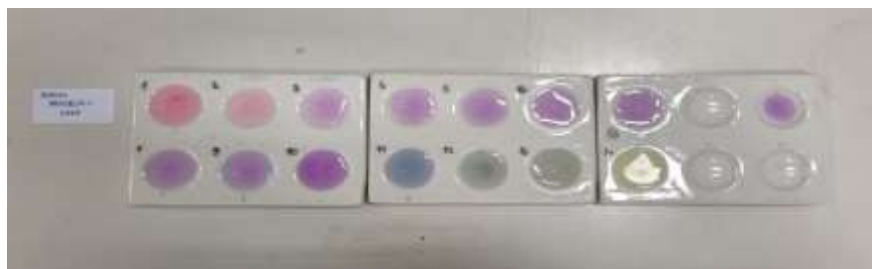
Slika 27. Indikator od latica roza orhideje i vode.
