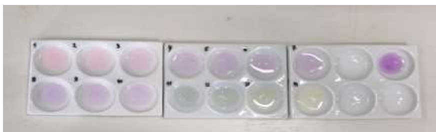
Slika 41. Indikator od latica roza orhideje i etanola.
