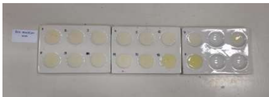
Slika 26. Indikator od latica žute orhideje i vode.
