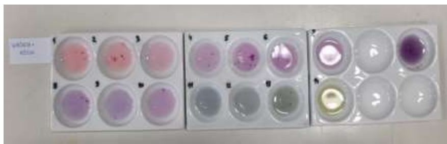
Slika 35. Indikator od latica ljubičaste orhideje i acetona.
