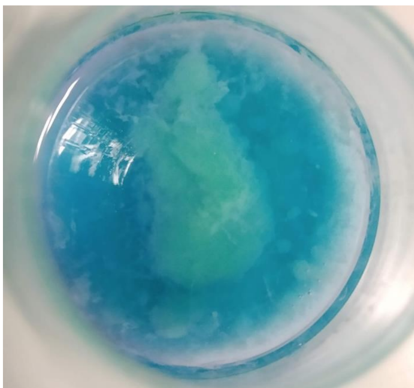
Slika 17. Nastanak zelenog taloga nakon sinteze.
