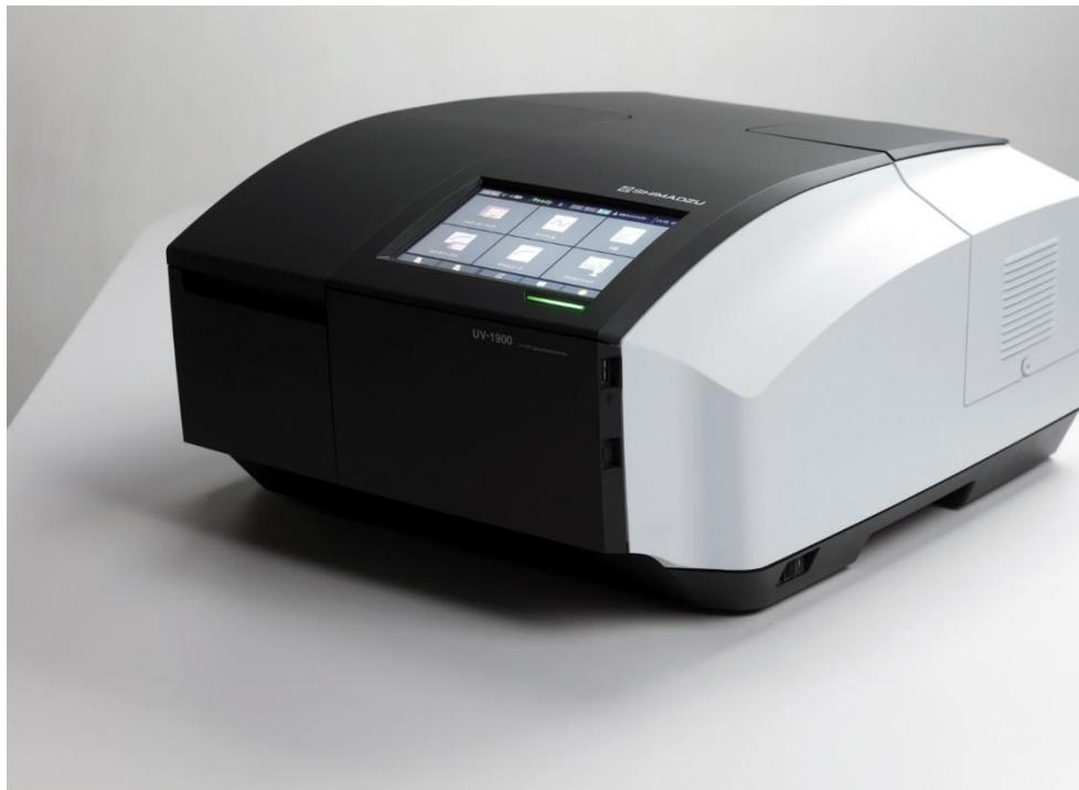
Slika 19. UV-1900 spektrofotometar [41].
