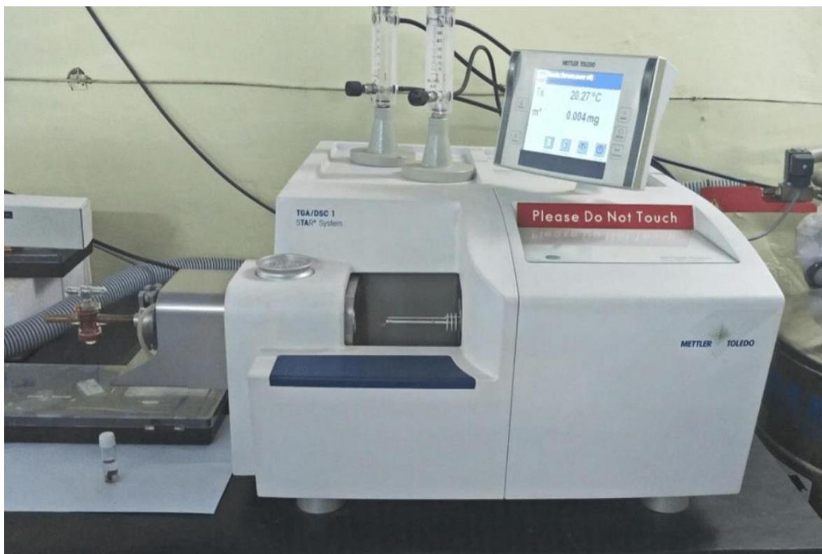
Slika 21. TGA-DSC Mettler Toledo System 1 uređaj [43].
