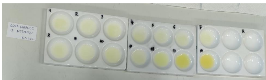
Slika 33. Indikator pripremljen od kore naranče i metanola.
