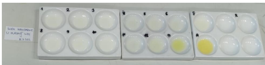
Slika 56. Indiktor pripremljen od kore mandarine i hladne vode.
