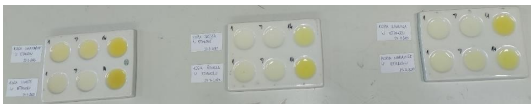
Slika 60. Indikatori pripremljeni od kore citrusa i etanola.
