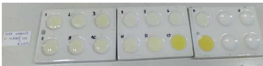
Slika 32. Indikator pripremljen od kore naranče i hladne vode.
