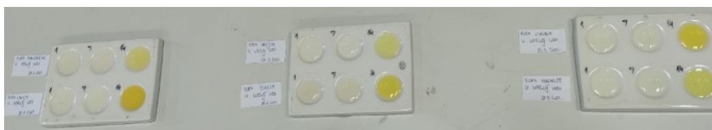
Slika 63. Indikatori pripremljeni od kore citrusa i vrele vode.
