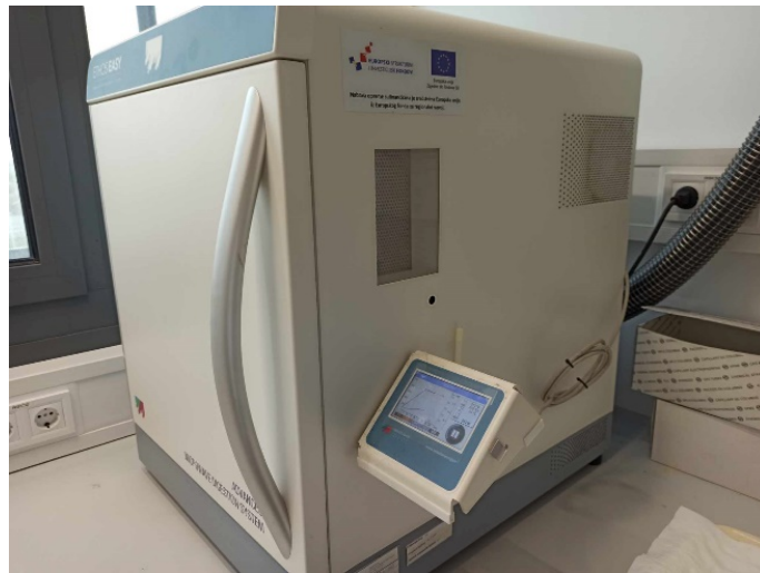
Slika 7. Mikrovalni uređaj Milestone
