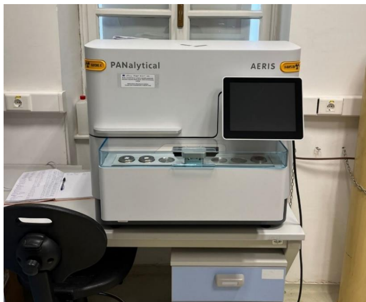
Slika 24. Uređaj za rendgensku difrakciju na prahu.
