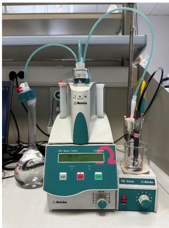
Slika 11. Sustav za potenciometrijska mjerenja.
