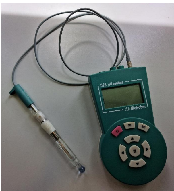
Slika 15. Prikaz korištenog pH-metra
