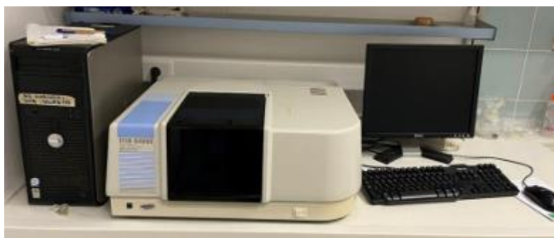
Slika 4. Uređaj za infracrvenu spektroskopiju Shimadzu FTIR 8400S.
