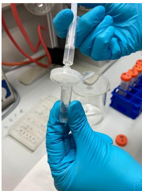
Slika 13. Filtriranje dobivenog supernatanta
