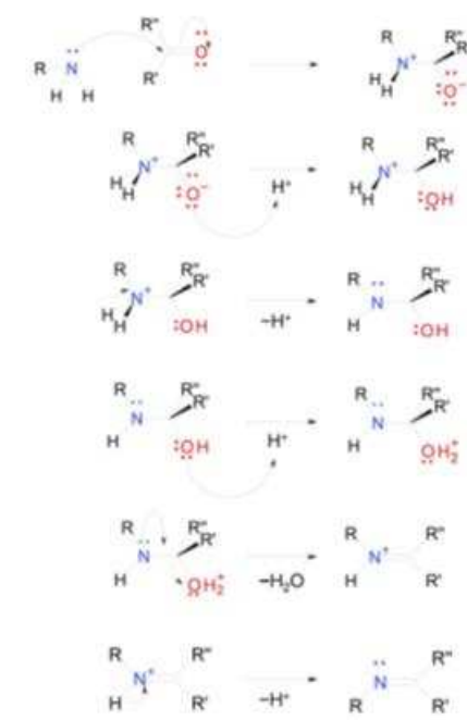
Slika 3. Mehanizam nastajanja Schiffovih baza [14].
