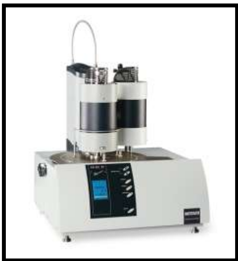
Slika 18. Netzsch instrument za TGA
