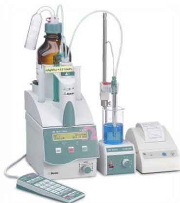
Slika 9. Aparatura za titraciju, 794 Basic Titrino
