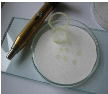
Slika 8. Prikaz izrade membrane ionsko selektivne elektrode
