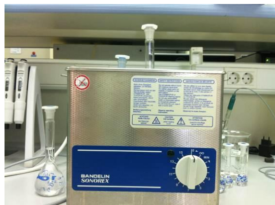
Slika 19. Prikaz ultrazvučne kupelji koja se koristila u opisanim ispitivanjima.
