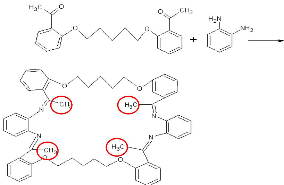
Slika 18 Predložena struktura i reakcija dobivanja Schiffove baze S101
