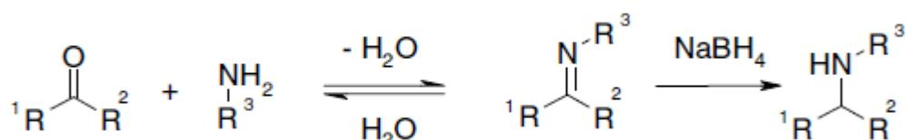
**Slika 5 Opći mehanizam dobivanja Schiffove baze**
